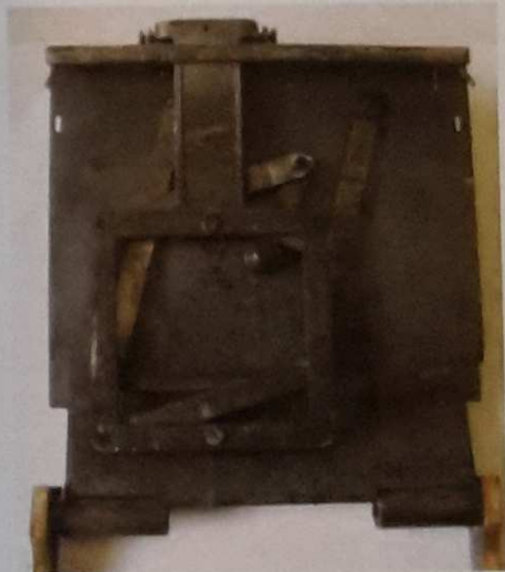
Bild 2 Vor der Restaurierung: Unterseite des aufgeklappten Schlittenoberteils. Man erkennt den Rahmen des Gummi-Typenträgers und die Hebelmechanik
